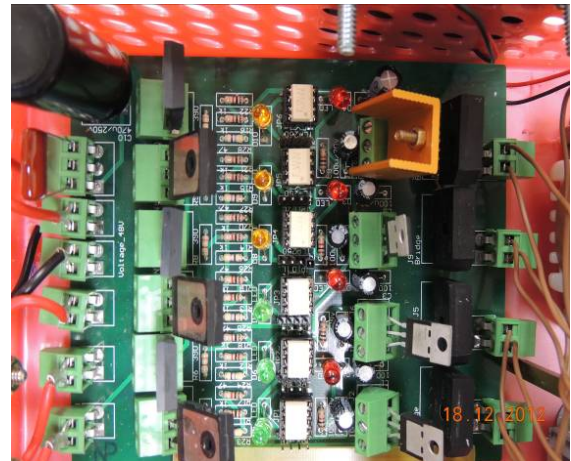
圖 11 三相換流器電路實體圖
